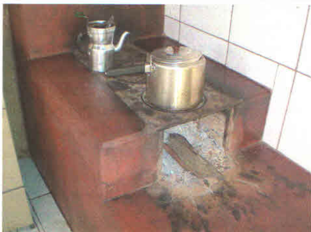
Foto 2: Nota-se o vão para abastecimento com lenha e as trempes onde são colocados os recipientes para cocção de alimentos. Data: dezembro/2011. Foto: Mariana Bracarense
